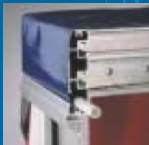
Vorderwand und Aluminium-Rungen Die optimale Lösung für eine schnelle, sichere und wasserdichte Planenmontage.
